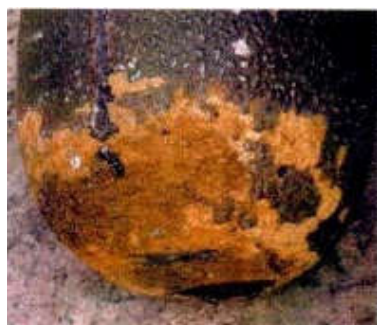
اکسیداسیون شدید به دلیل جهت نامناسب شعله
