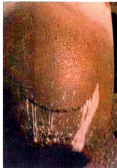
ترکی که به شکل "سپر" در دیواره بوته ایجاد شده است و دلیل آن قرار دادن شمش به صورت افقی درون بوته است
